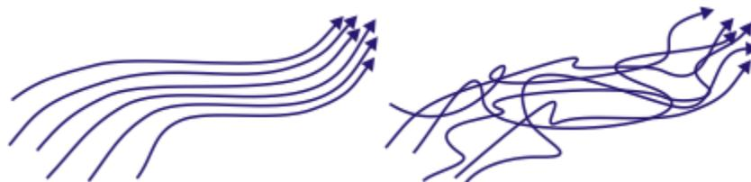
El flujo de la izquierda se llama **laminar**, dado que todas las líneas de circulación (o líneas de corriente) se desplazan una sobre otras siguiendo direcciones paralelas, como si fueran láminas que se desplazan. El flujo de la derecha se conoce como **turbulento**.
