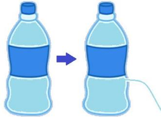
Cada molécula del líquido ejerce una presión sobre las moléculas contiguas y así hasta llegar a las paredes del recipiente.
