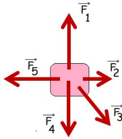
Acá por ejemplo tenemos fuerzas en tres direcciones, dado que  $\vec{F}_3$  puede descomponerse en sus componentes en x e y, como aprendimos para vectores en el Unidad 1.
