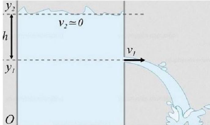
Entonces, se puede afirmar que la velocidad de salida del líquido por un orificio que está a altura  $h$  por debajo de la superficie libre del líquido, viene dada por la siguiente fórmula:
