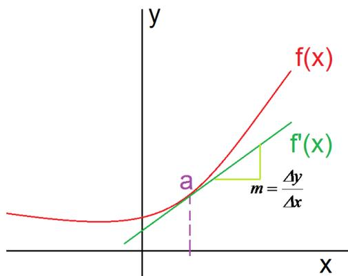
Si nos fijamos en el gráfico la pendiente (m) de la recta (en verde) se puede calcular como la pendiente de cualquier función lineal:
