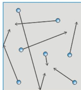
Las moléculas o átomos que conforman a los líquidos y a los gases están en movimiento constante, dado por su energía cinética. Sus moléculas se mueven en forma bastante caótica (desordenada). Rara vez las velocidades de sus moléculas son medianamente uniformes, ni en módulo ni en dirección ni sentido. Aún cuando veas un líquido en reposo,
