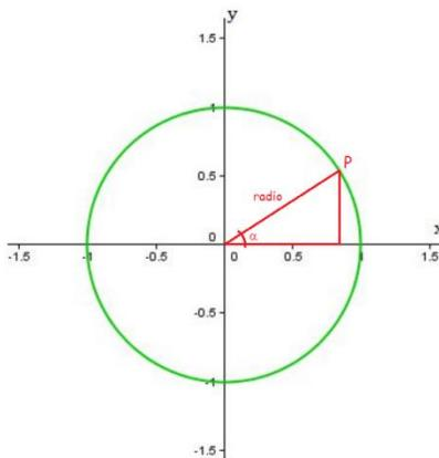
Nótese que la hipotenusa del triángulo que dibujamos, ahora tiene, en todo momento, una longitud igual a 1, que coincide con el radio de la circunferencia. También vamos a mencionar que el perímetro de un círculo es  $2 \pi r$ . Dado que el círculo que dibujamos es de radio igual a 1, el perímetro de este círculo es  $2 \pi$ . Del apartado anterior sabemos que la función seno de un ángulo (en este caso lo llamamos  $\alpha$ ), puede definirse como:
