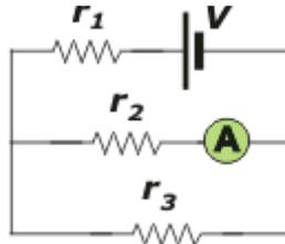
Para que no afecte la circulación de corriente ni las caídas de voltaje, el amperímetro ideal es aquel de resistencia nula ( $R_A = 0$ ). Como esto no es posible en la práctica, se buscan para su elaboración materiales de resistencia despreciable respecto a las del circuito.
