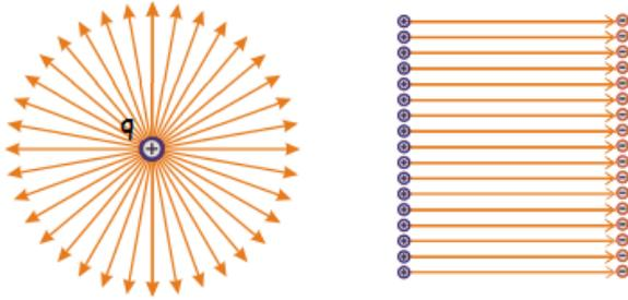
El campo uniforme se produce cuando se tienen dos planos paralelos cargados uniformemente con cargas opuestas. Esto es lo que ocurre en la membrana plasmática de todas las células, que es similar a un capacitor de placas paralelas.
