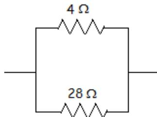
7. Aplicando la Ley de Ohm, determinar la intensidad de corriente ( $i$ ) que circula por el circuito siguiente
