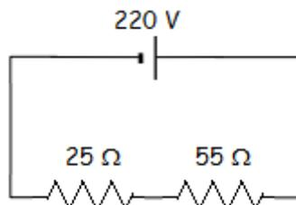
8. Determinar el valor de la resistencia equivalente de los siguientes circuitos:
