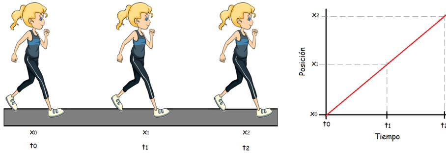
Dado que la velocidad es un valor constante, cuando un móvil se desplaza en MRU, el gráfico de la posición que tiene el móvil en función del tiempo es una línea recta cuya pendiente es la velocidad media. Recordemos de la Unidad 1 de Matemática, que la ecuación de una recta es
