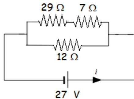
11. Dado el circuito de la figura, calcular la resistencia equivalente
