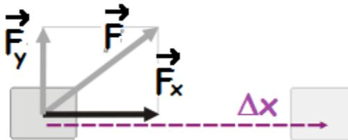
El trabajo es una magnitud que surge de un proceso que transcurre en cierto intervalo de tiempo, y en el que hay algún desplazamiento. No es una magnitud instantánea, como la velocidad, o la energía, o tantas otras que se definen para un instante de cierto sistema.
