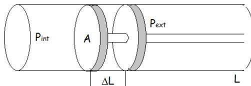
**Trabajo de expansión.** Cuando el gas se expande y mueve el pistón de área  $A$  por una distancia  $\Delta L$ , se realiza el trabajo  $\Delta L \times F$ , donde  $F = A \times P_{ext}$  (recordar que  $P = F/A$ , siendo  $F =$  fuerza)
