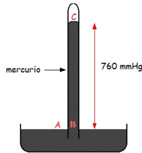
Usando el **teorema general de la hidrostática** podemos calcular la presión. Tomaremos un punto en la superficie que está expuesta al aire (A) y otro a la misma altura, pero dentro de la columna (B), por lo que está expuesto a la presión del líquido que tiene encima. Entonces,
