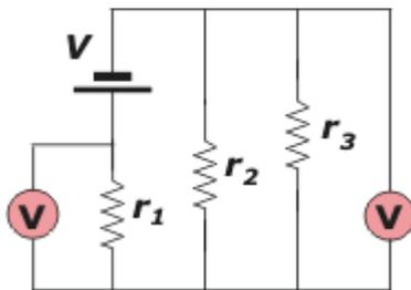
El voltímetro mide la diferencia de potencial que existe entre los dos puntos que toquen sus cables, de modo que para medir una diferencia de potencial cualquiera, basta con apoyar las puntas en los lugares de conexión de cualquier elemento eléctrico de un circuito (una resistencia, una batería, un capacitor). Por ejemplo:
