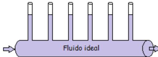
Recordar que la energía mecánica se conserva sólo cuando no hay fuerzas no conservativas actuando ( $W_{NC} = \Delta E_M$ ), de modo que el principio de Bernoulli sólo puede aplicarse a fluidos en los que la viscosidad (el rozamiento) sea despreciable. El principio de Bernoulli sólo se puede aplicar a fluidos ideales. Aún así, representa una herramienta sumamente útil y descriptiva.
