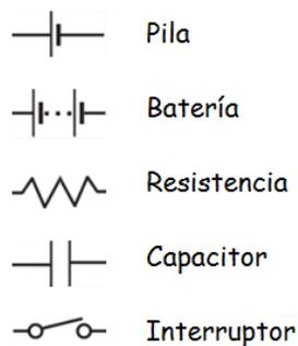
Nótese que en la pila, el polo positivo está representado por la placa de mayor longitud, siendo el polo negativo de menor longitud. Varias pilas conforman una batería. El **capacitor** se representa con dos líneas de igual longitud. Un ejemplo del circuito más sencillo con una resistencia y una pila en serie, sería:
