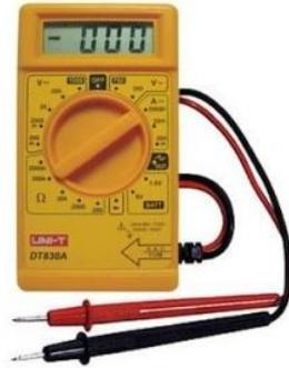
En la actualidad, amperímetro y voltímetro vienen integrados en un único instrumento llamado **multímetro**. Tienen además otras funciones, entre las que se destaca el óhmetro, que mide valores de resistencias.
