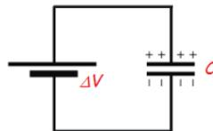
Una vez conectados de esta manera, de los extremos de la pila salen cargas que van a almacenarse en las placas del capacitor hasta que el mismo alcanza una diferencia de potencial igual a la de la pila. Recordemos que entre las placas no podrá haber conducción eléctrica, dado
