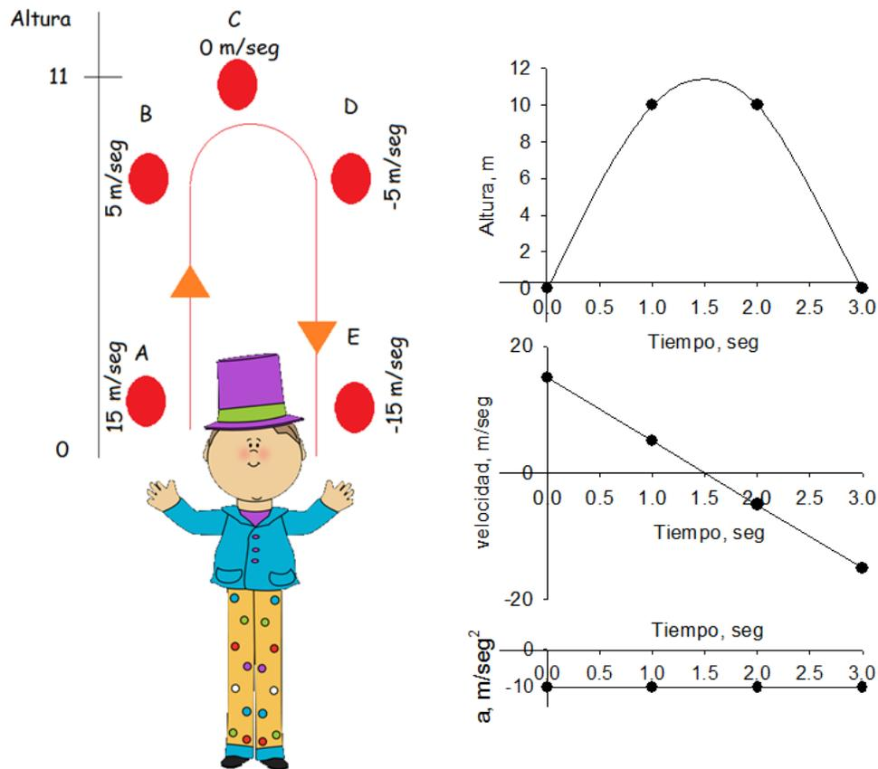
Notar que, a igual altura, el módulo de la velocidad es el mismo, y que la velocidad disminuye hasta hacerse cero en la altura máxima.
