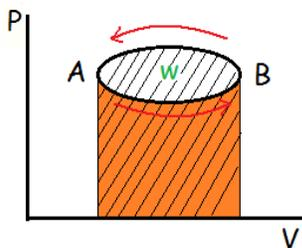
**Trabajo de expansión de un proceso cíclico.** Cuando se efectúa el recorrido de A hacia B en el sentido de la flecha, el trabajo ( $P \times \Delta V$ ) es igual al área encerrada (rayada). Si la dirección del movimiento es la opuesta (de B hacia A, por el camino indicado con la flecha superior), el trabajo se obtendrá como el área coloreada en naranja.
