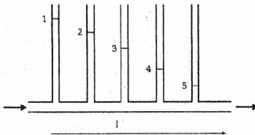
a) Grafique en papel milimetrado la presión ( $P$ ) en cada manómetro vs. longitud ( $l$ ), y a partir del mismo determine la velocidad de circulación del líquido.
