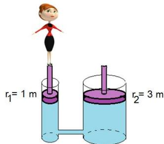
Considerando los radios de los pistones que se muestran (asuma  $g = 10 \text{ m/s}^2$ ), el peso máximo que podría elevar mediante el pistón derecho es:
