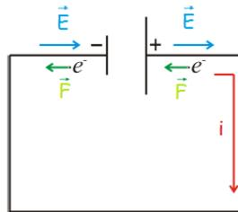
En ausencia de campo eléctrico, los electrones (u otros portadores de carga) están en movimiento aleatorio. Sin embargo, bajo la influencia de un campo eléctrico externo, su movimiento no será completamente aleatorio sino que se desplazará en la dirección del campo eléctrico pero sentido contrario. La velocidad a la que lo hacen se denomina velocidad de desplazamiento  $v_d$ , que es del orden de 1 mm/s.
