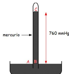
Usando el **teorema general de la hidrostática** podemos calcular la presión. Tomaremos un punto en la superficie que está expuesta al aire (A) y otro a la misma altura, pero dentro de la columna (B), por lo que está expuesto a la presión del líquido que tiene encima. Entonces,
