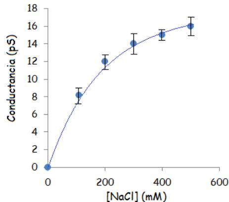
**Errores experimentales.** Obsérvese que en el gráfico cada punto experimental está representado junto con una barra vertical que lo atraviesa, indicando el error asociado con la medición (en este caso, el error estándar, que veremos en mayor detalle en la sección de Bioestadística).
