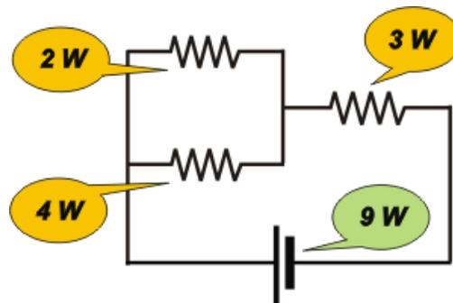
Las fuentes, pilas o baterías entregan energía, el resto de los elementos, disipan toda la energía en su totalidad (aunque parte de la energía se "pierda" como calor). El kilowatt-hora, kWh, es una unidad de energía, no de potencia. Tiene un nombre engañoso, se trata del producto entre dos unidades: kilowatt y hora. La primera es indudablemente de potencia, mil watts; y la segunda de tiempo. El producto de potencia por tiempo, da energía.
