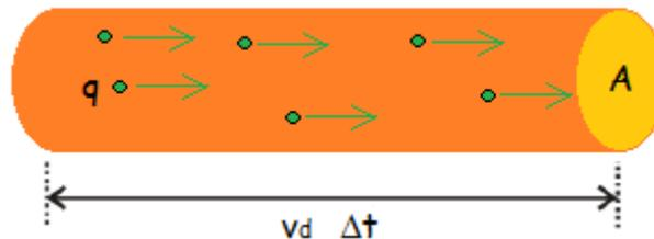
Si por un alambre conductor circulan  $n$  cargas  $q$  por unidad de volumen, la intensidad de corriente vendrá dada por:
