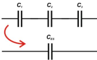
Dos o más capacitores están conectados en serie cuando están conectadas entre sí por sus placas de polaridad opuesta. El grupo puede reemplazarse por un único capacitor, capaz de acumular la misma carga que el conjunto, y que por ello recibe el nombre de capacitor equivalente en serie,  $C_{ES}$ .
