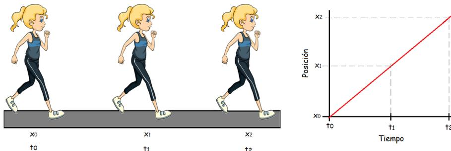
Dado que la velocidad es un valor constante, cuando un móvil se desplaza en MRU, el gráfico de la posición que tiene el móvil en función del tiempo es una línea recta cuya pendiente es la velocidad media. Recordemos de la Unidad 1 de Matemática, que la ecuación de una recta es
