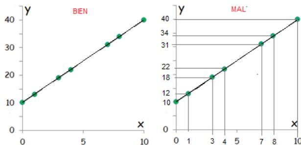
**Gráfico de función lineal.** Obsérvese que la representación de la izquierda está correctamente graficada, mientras que la de la derecha (gráfico mal realizado) carece de escala y se indican los valores de cada medición. Si bien los puntos están bien interceptados en los ejes, no es la forma correcta de mostrar los datos.
