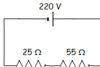
8. Determinar el valor de la resistencia equivalente de los siguientes circuitos:
