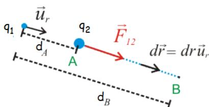
Cuando se encuentra bajo la única acción de la fuerza electrostática, la carga de prueba se moverá siempre en el sentido en el que disminuye su energía potencial ( $U_A > U_B$ ). De forma general se toma como origen para la energía potencial el infinito, de modo que cuando la distancia entre las dos cargas es infinita, la energía potencial entre ambas
